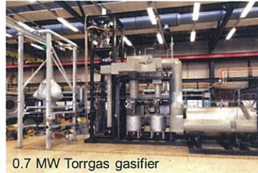
0.7 MW Torrgas gasifier
