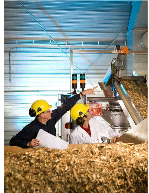
ECN 50 kg/h torrefaction pilot-plant
