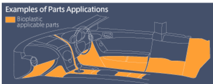
Figuur 9. Illustratie van Mazda, de gele delen worden gemaakt van bioplastics.
