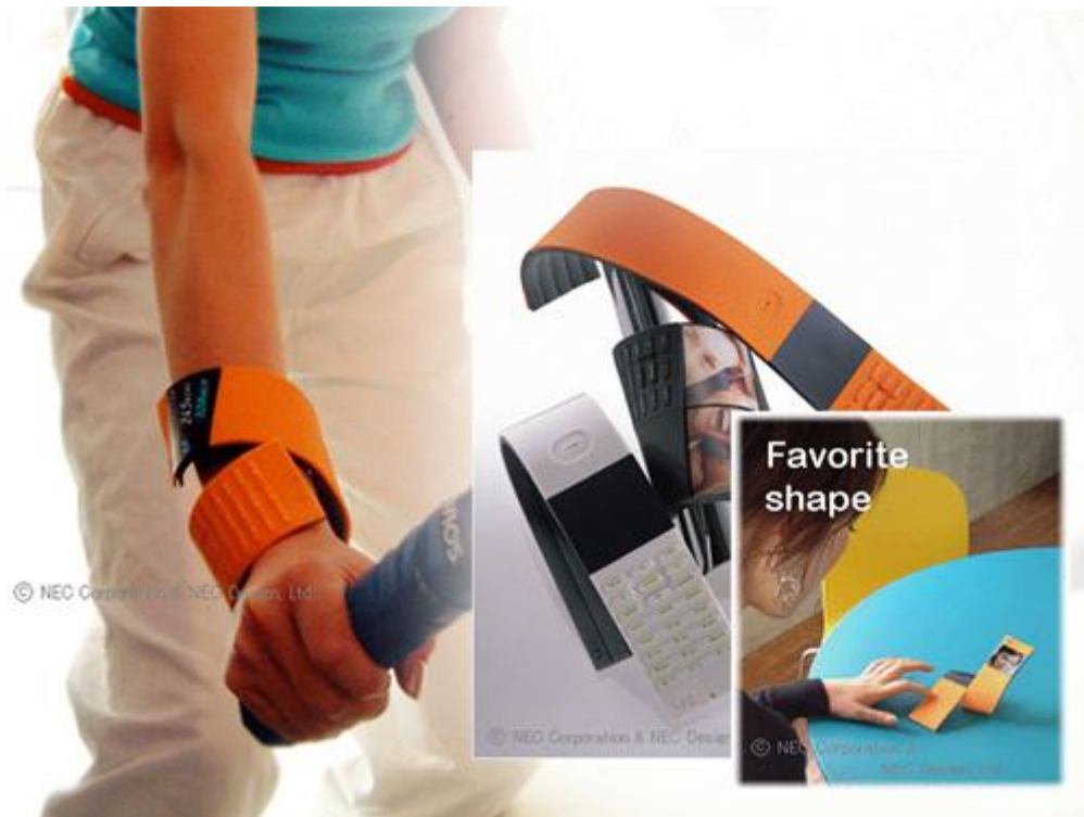
Figuur 5. Hervormbare mobiele polstelefoon gemaakt van bioplastics met 'vormgeheugen'.
