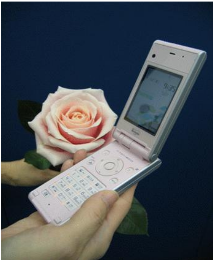
Figuur 2. NEC/NTT Mobiele telefoon met PLA/Kenaf-bioplastics
