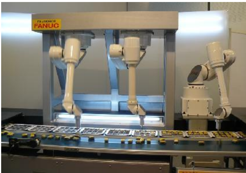
Figuur 1. Twee FANUC robotarmen werken in samenhang en pakken kleine doosjes op.
