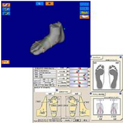
Figuur 2b: Stap 2 - het IO-software systeem genereert een 3d-weergave op basis van de laserscans
