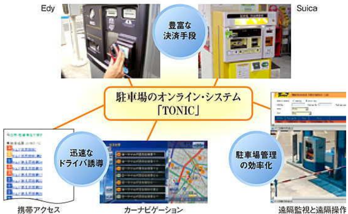
Figuur 2. Functies van TONIC (van linksboven): automatische betaling (Edy, Suica), informatie (via mobiele telefoon of navigatiesysteem) en bediening op afstand met cameratoezicht
