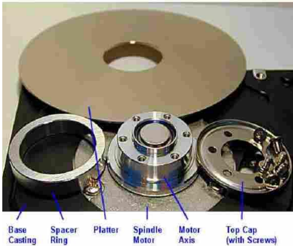
Figuur 3 – Onderdelen van een harde schijf van 3,5 inch uit een bureau PC (vertaling *9).
