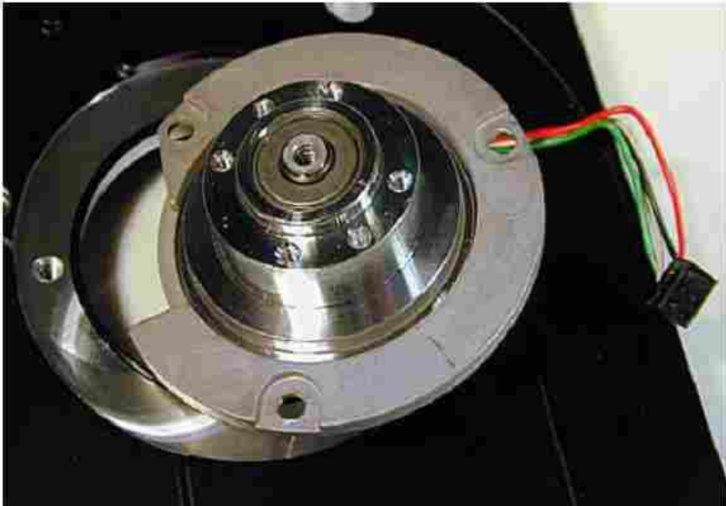
Figuur 2 - Spilmotor uit een standaard harde schijf van 3,5 inch uit een bureau PC.
