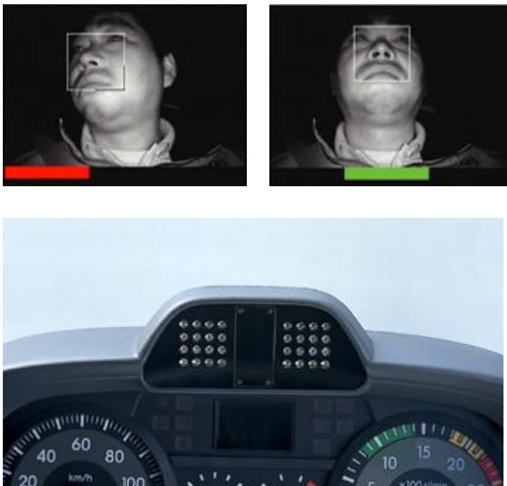
Figuur 7. Registratie van de positie van het hoofd van de bestuurder
