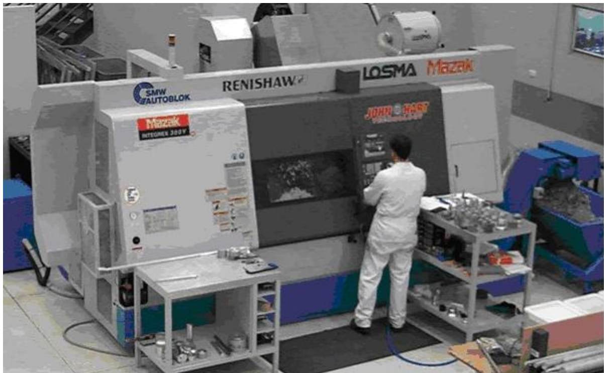
Figuur 3. Yamazaki Mazak Interex 300Y – Multi-functioneel 5-assig CNC machine centrum
